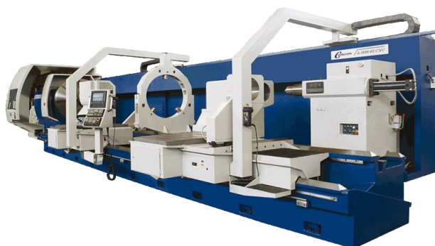
2.7 attēls. Pielāgota virpa ar četriem kustīgiem atbalstiem A-1600 4G (apstrādātās sagataves garums var būt līdz 15000 mm, diametrs - 1300 mm, masa - 15 t un spīļpatronas cauruma diametrs - 550 mm) (Gurutzpe)
