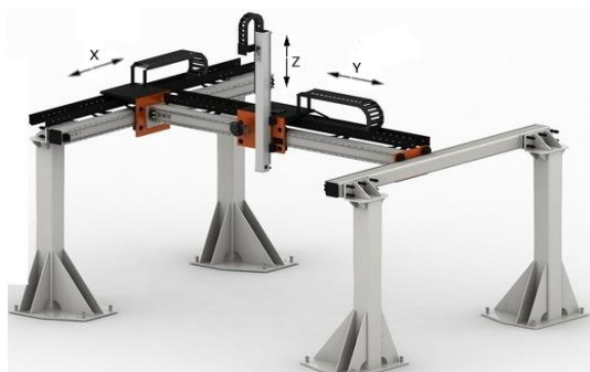
9.1. attēls. Dekarta robotu konfigurācija un darba telpa
