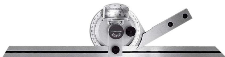
4.7. attēls. Goniometra nonija skala ar palielināmo lupu (Marui-Keiki Co., LTD.)
