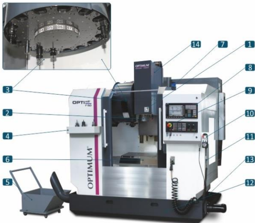
2.69. attēls. CNC frēžēšanas darbgalda F150 (Optimum Maschinen Germany GmbH) galvenās sastāvdaļas: 1 – slēdzis, lai atbrīvotu un ievietotu instrumentu darba vārpstā, 2 – vārpsta, 3 – instrumentu mainītājs ar 16 vai 24 instrumentu magazīnu, 4 – instrumentu plaukts, 5 – skaidu konteiners, 6 – apstrādes galds, 7 – signāllampa, 8 – vadības panelis, 9 – avārijas apturēšanas spiedpoga, 10 – tālvadības pults, 11 – tīrīšanas pistole, 12 – skaidu konveijers, 13 – pamatne, 14 – vārpstas korpuss
