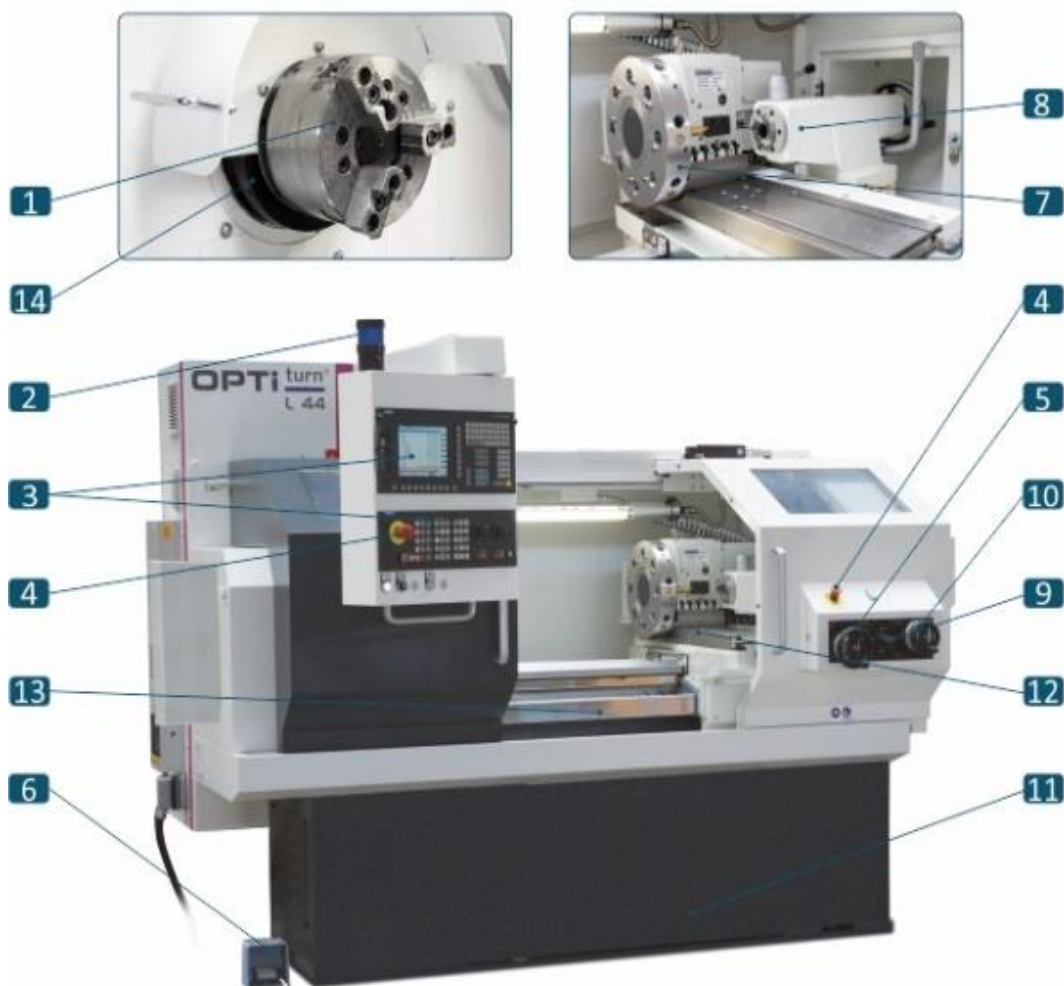
2.70. attēls. CNC virpas L44 ( Optimum Maschinen Germany GmbH ) galvenās sastāvdaļas: 1 – spļpatrona, 2 – signāllampa; 3 – vadības panelis; 4 – avārijas apturēšanas poga; 5 – rokas rats, manuālā pārvietošana pa Z asi, 6 – pedālis virpas spļpatronas atlaišanai/iespīlēšanai, 7 – revolvergalva, 8 – aizmugures balsts, 9 – X un Z ass vadīšanas svira, 10 – rokas rats, manuālā pārvietošana pa X asi, 11 – pamatne, 12 – kariete, 13 – lineāras vadotnes, 14 – priekšējais balsts
