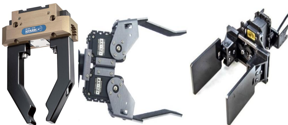
9.28.attēls. Sērijveida mehāniskās pirkstu satveres formas
