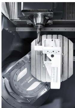
2.30. attēls. Piemēri caurumu urbšanai ar CNC frēzēšanas darbgaldiem (DMG MORI Company Ltd)
