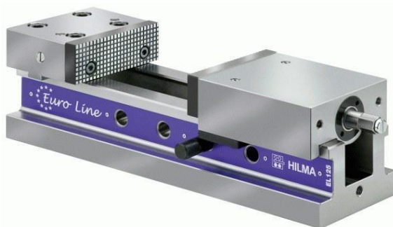
2.54. attēls. Hidrauliskās skrūvspīles (Römheld GmbH Friedrichshütte)
