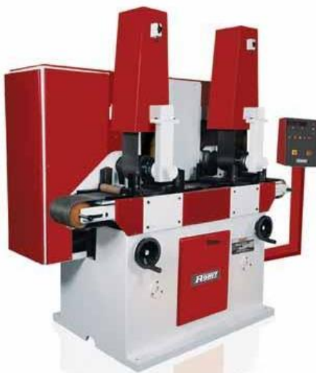
3.34. attēls. Lentas tipa pulēšanas darbgalds Model-ZX-150-2 (Rohit Polishers)
