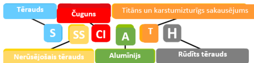
3.39. attēls. Apstrādājamo materiālu grupēšana, pamatojoties uz materiālu klasifikācijas kodiem
