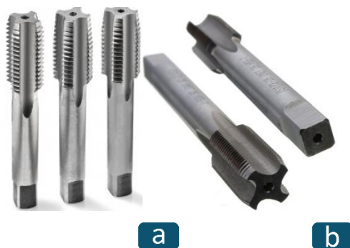
3.22. attēls. Vītņurbju komplekti manuālajai vītņgriešanai: a-trīs vītņurbju komplekts trijiem griezieniem (Thürmer Tools); b-divu vītņurbju komplekts diviem griezieniem;
