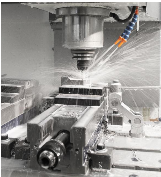
6.1. attēls. Neapstrādātas virsmas frēzēšana
