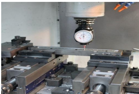
2.64. attēls. Atskaites plākšņu identifikācija ar 3D mēřtaustu
