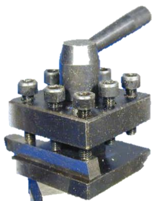
2.77. attēls. Četru pozīciju instrumentu turētājs virpošanas instrumentu ieslēšanai (PracticalMachinist.com)
