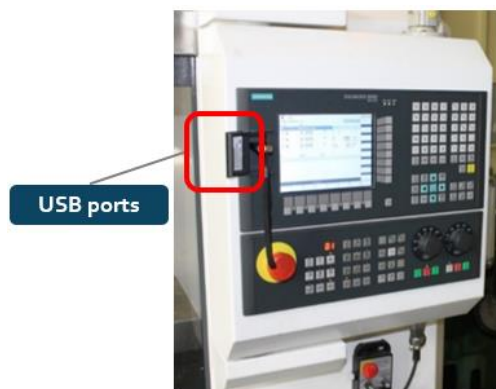
5.60. attēls. Datu pārsūtīšana uz iekārtas vadību (Optimum Maschinen Germany GmbH)
