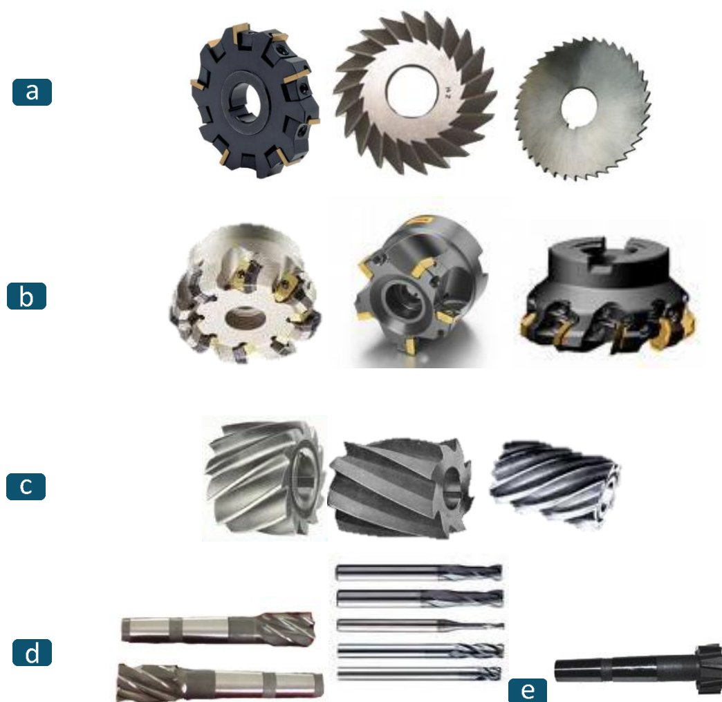
3.11. attēls. Griezējinstrumentu piemēri: a- disku frēze; b- kroņveida; c-cilindriskie griezējinstrumenti; d- gala frēze; e- T-veida frēze (Gehring Technologies GmbH)
