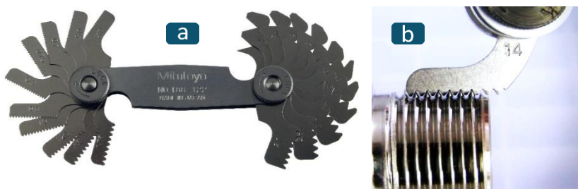
4.20. attēls. Soļa mērītājs ar plāksnēm: a) plāksņu komplekts (Mitutoyo America Corporation) un
