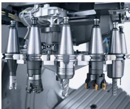
2.33. attēls. Apstrādes centru instrumentu magazīnu piemēri. DMU 50 un DMU 70 frēzēšanas darbgaldi, firma DMG MORI
