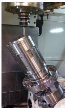
2.30. attēls. Piemēri caurumu urbšanai ar CNC frēzēšanas darbgaldiem (DMG MORI Company Ltd)
