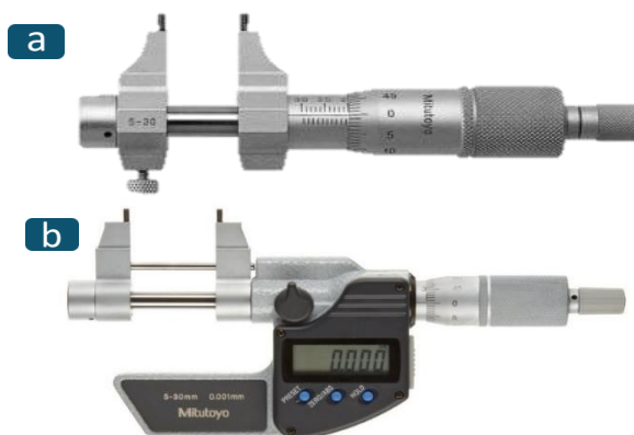
4.11. attēls. Dziļuma mikrometrs: a) ar iedaļu skalū, b) ar digitālo indikatoru (Mitutoyo America Corporation)
