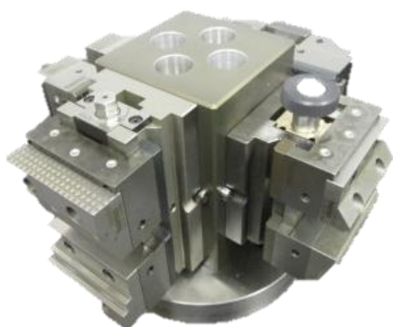
2.45. attēls. Iespīlēšanas kubs (MTD Ebusiness Ltd)
